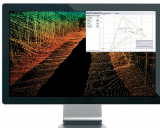
POSPac MMS 中 POSPC 模块正在将激光雷达扫描仪获取的原始数据与导航数据解算处理获得地理参考点云数据 (如上图所示)。
